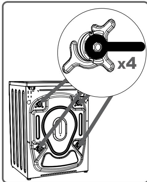
Вытащите предохранительные транспортировочные винты.
