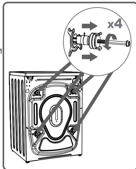
**ПРИМЕЧАНИЕ:** Перед началом эксплуатации стиральной машины удалите все транспортировочные винты. Гарантия не распространяется на неисправности, возникающие в машинах, работающих с транспортировочными винтами.
