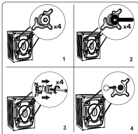
1. Перед использованием стиральной машины необходимо удалить 4 транспортировочные болты и резиновые прокладки в задней части машины. Если болты не удалены, они могут вызвать сильную вибрацию, шум и выход машины из строя, а также привести к аннулированию гарантии.
