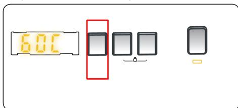
Когда вы выбираете программу, максимальная температура для этой программы выбирается автоматически. Для изменения температуры нажимайте кнопку регулировки температуры воды до тех пор, пока на цифровом дисплее не отобразится требуемая температура.
