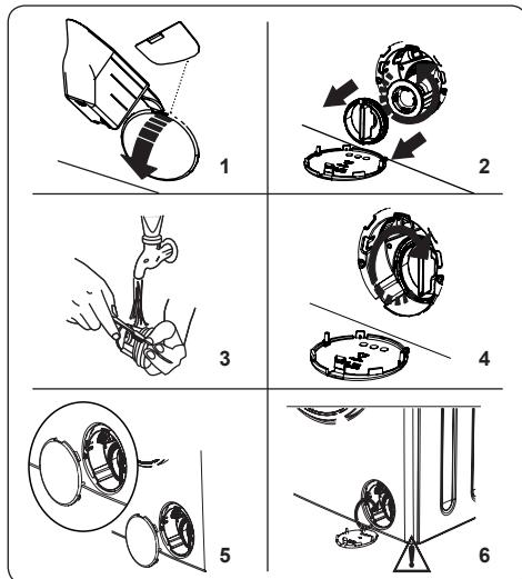
Фильтровальная система насоса машины продлевает срок службы насоса, предотвращая попадание ворсинок в машину.
