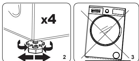
2. Чтобы увеличить высоту машины, поверните ножки по часовой стрелке. Чтобы уменьшить высоту машины, поверните ножки против часовой стрелки.
