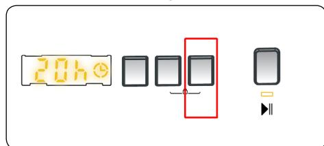
Эту дополнительную функцию можно использовать, чтобы отложить запуск цикла стирки на период от 1 до 23 часов.
