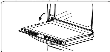
2. Откройте опорный подвес (а) (с помощью отвертки) до конца.
