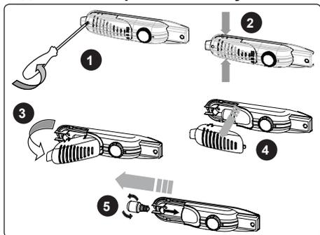
1. Отверните винт на крышке с помощью отвертки. (Рис. 1)
