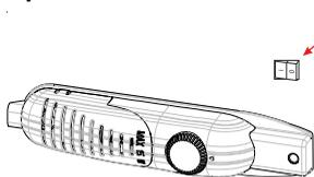
С целью обеспечения надлежащей работы прибора при температуре ниже 20 °С, следует нажать кнопку, расположенную возле термостата. После того как температура поднимется выше 20 °С, необходимо нажать кнопку еще раз, чтобы отключить данную функцию.
