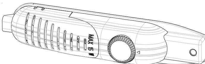
Термостат автоматически регулирует температуру внутри холодильной и морозильной камеры. Путем изменения позиции ручки с MIN. («1») на MAX. («5»), может быть получена более холодная температура.
