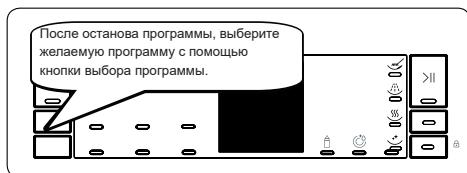
**ПРИМЕЧАНИЕ:** Функция блокировки от детей включает/отключается нажатием кнопки таблетированного моющего средства (5) примерно на 3 секунды. При включении этой функции мигают все индикаторы и на индикаторе оставшегося времени один раз отображается сообщение «CL» (4). При выключении этой функции все индикаторы и сообщение «CL» мигнут дважды.
