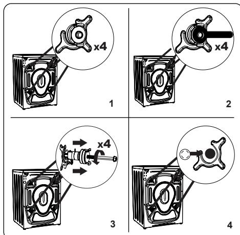
1. Перед использованием стиральной машины необходимо удалить 4 транспортировочные болты и резиновые прокладки в задней части машины. Если болты не удалены, они могут вызвать сильную вибрацию, шум и выход машины из строя, а также привести к аннулированию гарантии.
